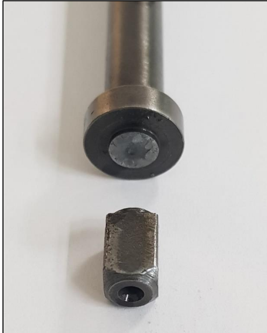
Fotografía No. 6: Evidencia fractura por torsión alternante (Eje fusible)
